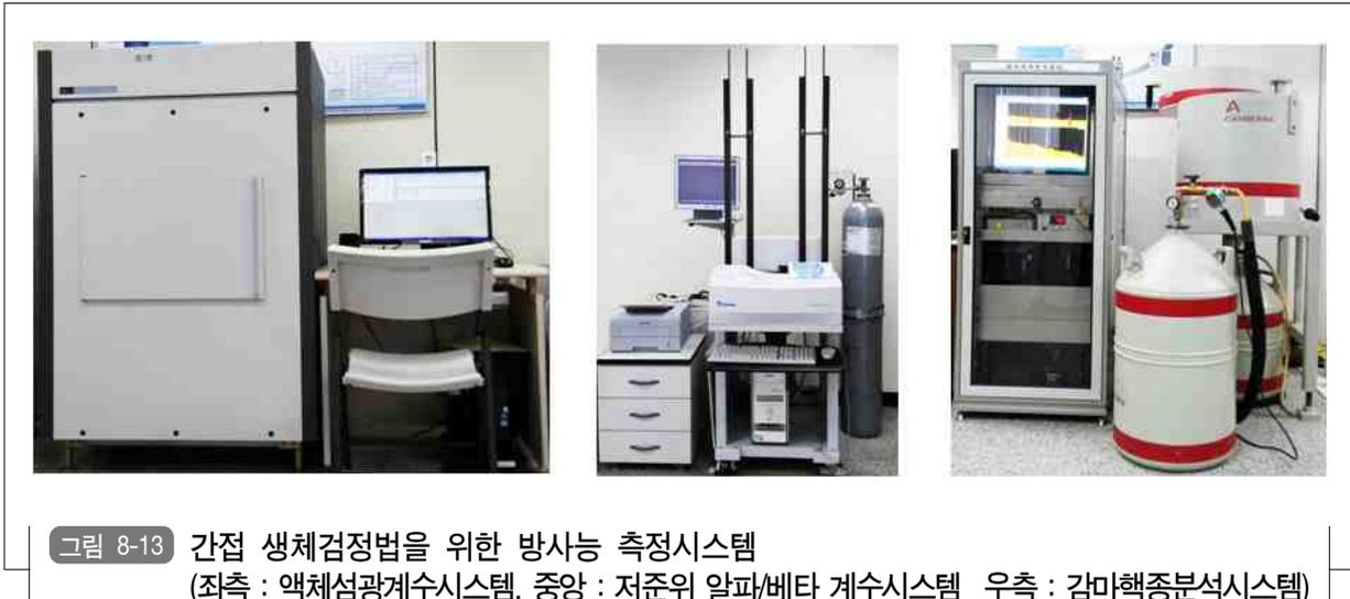
그림 8-13 간접 생체검정법을 위한 방사능 측정시스템
